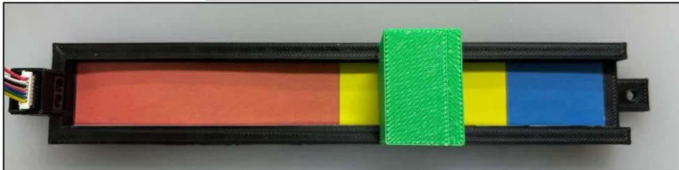
図 9 測距用スライダ装置、スライダ、測距センサ設置図
